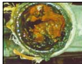
Verzinktes Verteilerrohr vor und nach der Behandlung mit WELLAN® 2000 in einem Privathaushalt.
